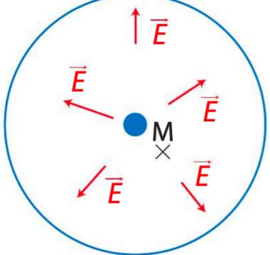
Le schéma ci-dessus représente le champ électrostatique en quelques points d'un condensateur cylindrique.
