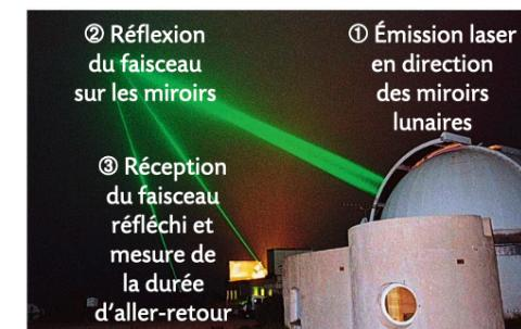
Une mesure a donné pour l'aller-retour de la lumière une durée  $\Delta t = 2,429\ 227\ 864\ 1$  s avec une précision de  $3 \times 10^{-10}$  s.
